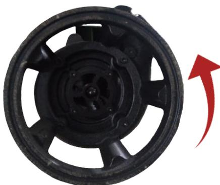
Para realizar o teste de verificação do sentido de fluxo, assegure-se que a reação da bomba esteja limitada aplicando somente um “pulso” – liga/desliga. Mantenha os arredores livres de objetos e pessoas. Caso seja constatada a necessidade de inverter fases para corrigir o sentido da rotação, providencie o desligamento geral da energia.
