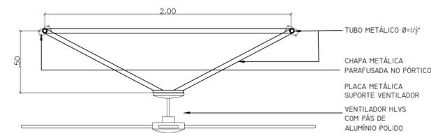
5 ESC DETALHE 01 - ESTRUTURA DE FIXAÇÃO VENTILADOR
