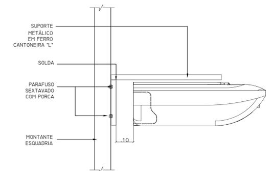
8 ESC DETALHE 02 - FIXAÇÃO EVAPORADORA
