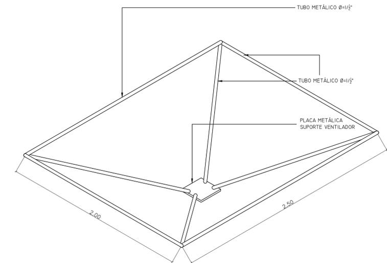
6 ESC DETALHE ISOMÉTRICA ESTRUTURA VENTILADOR
