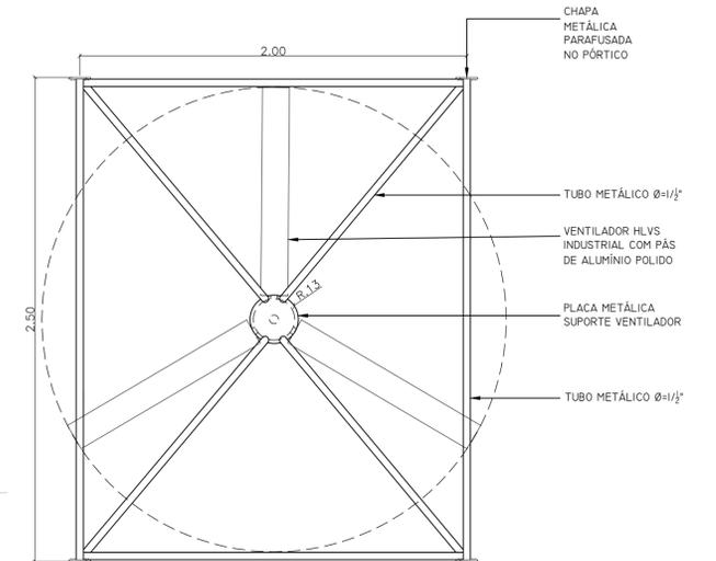
4 ESC DETALHE PLANTA ESTRUTURA DE FIXAÇÃO VENTILADOR
