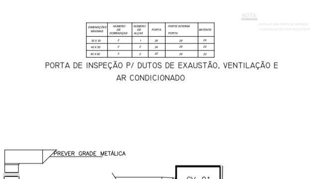
PORTA DE INSPEÇÃO P/ DUTOS DE EXAUSTÃO, VENTILAÇÃO E AR CONDICIONADO
