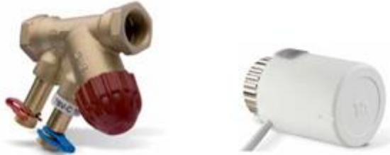
O atuador será tipo termoeletrico de duas posições (aberto/fechado), On/Off. Possui as versões com tensão de alimentação de 230V ou 24V e para ambos os casos as opções de Normal Aberto (NA) ou Normal Fechado (NF). Trabalha com temperatura ambiente de até 50°C e uma temperatura máxima do fluido de 100°C. A versão com alimentação de 230V possui um variador para proteção contra sobre tensão.
