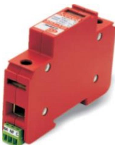
Dispositivo de Proteção contra Surtos (DPS), monopolar, Classe I/II (NBR IEC 61.643-1), do tipo limitador de tensão, composto por varistor de óxido de zinco (MOV) associado a um dispositivo de desconexão térmica (sobretemperatura) e elétrica (sobrecorrente).
