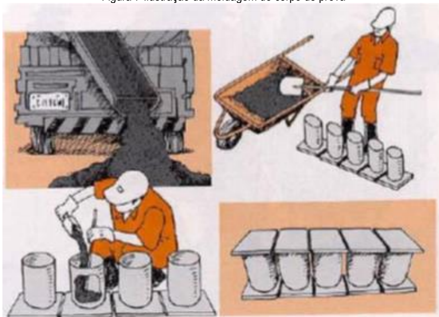
Figura 7 Ilustração da moldagem do corpo de prova
