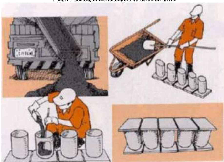
Figura 7 Ilustração da moldagem do corpo de prova
