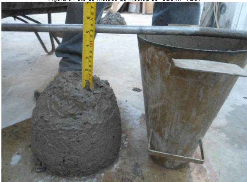
Figura 6 Foto do método de medida do “SLUMP TEST”
